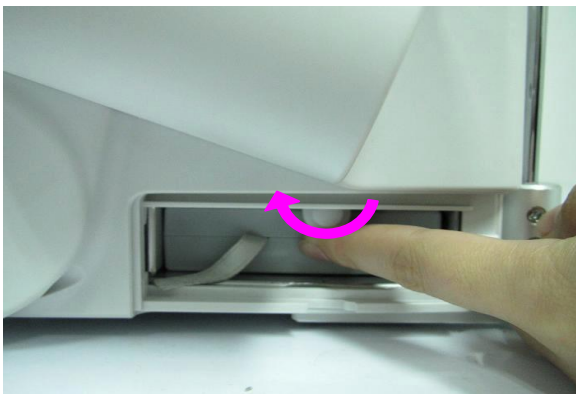
⑤ Поверните рычаг по часовой стрелке, чтобы зафиксировать батарею на месте
