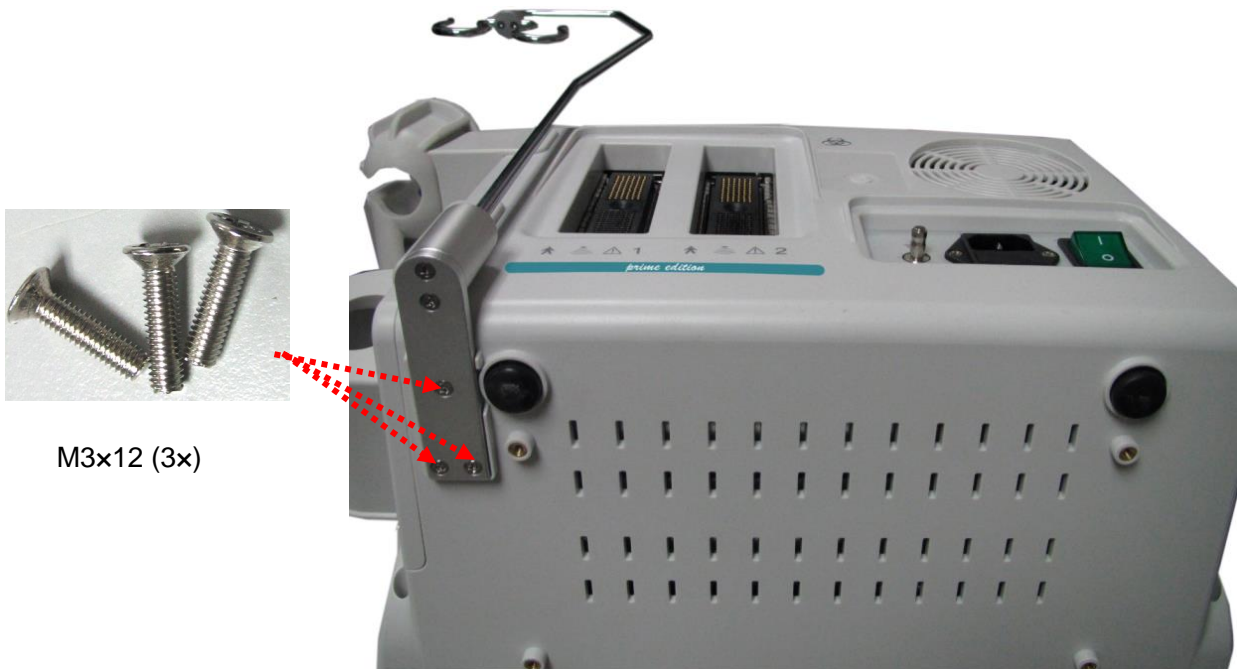
Рис. 4-1 монтаж держателя кабеля на главный процессор
