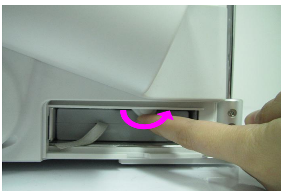
③ Поверните рычаг против часовой стрелки, чтобы скрыть его
