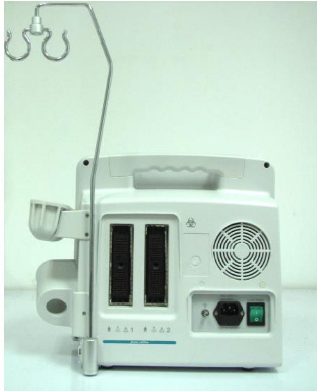
Рис. 4-2 Главный процессор с держателем кабеля
