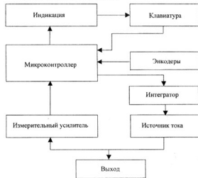
Рисунок 1.1.- Функциональная схема гальванизатора «Поток-Бр»
