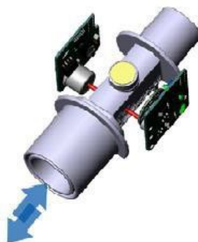
Рисунок. Направление светового пути в адаптере IRMA
