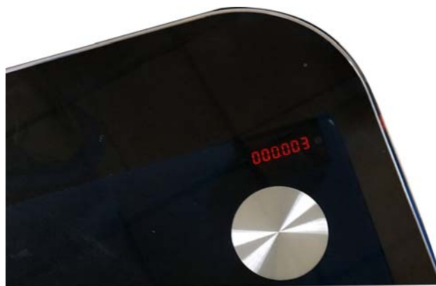
Рисунок А3.21 Индикатор счетчика наработки бактерицидной лампы
