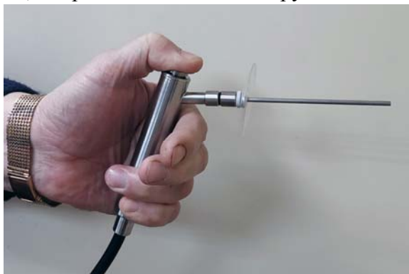
Рисунок А6.5 Рукоятка для промывания с наконечником и противобрызговым устройством Воронка с подключенной вакуумной рукояткой в месте промывания.
