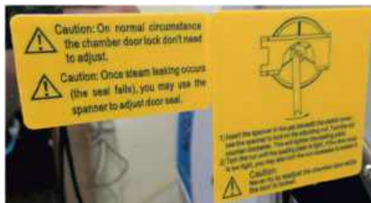
Рис. 41 – Предостережение: В обычных условиях замок дверцы камеры не нужно регулировать. Если происходит утечка пара (нарушение герметичности), вы можете использовать гаечный ключ для регулировки уплотнения дверцы.
