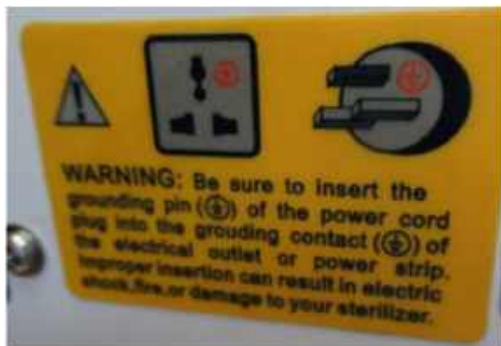
Рис. 40 – ВНИМАНИЕ: Обязательно вставьте заземляющий контакт вилки шнура питания в заземляющий контакт электрической розетки или удлинителя. Неправильная установка может привести к поражению электрическим током, возгоранию или повреждению стерилизатора
