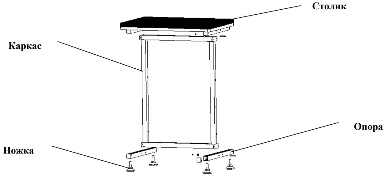
1. Соединить столик (поз.1) с каркасом (поз.2) при помощи винта (поз. 4), гайки (поз.6) и шайбы (поз. 5) (смотри табл. 2).
