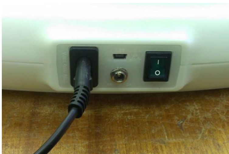
Рисунок 11. Подключение к сети переменного тока напряжением 220 В
