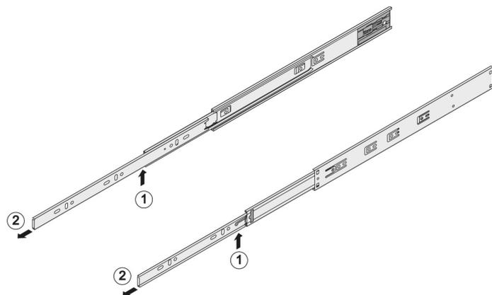
8.4 В процессе эксплуатации может потребоваться снятие выдвижного ящика. Для этого необходимо выдвинуть ящик на полную длину, а затем, нажав на фиксатор (1) между узкой и средней частями направляющих, вытянуть ящик на себя (2). Для обратного действия достаточно задвинуть ящик, фиксатор сработает автоматически.
