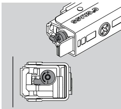
8.3 В процессе эксплуатации может потребоваться регулировка демпфирования двери. Регулировка осуществляется вручную. Регулировочный рычаг в положении минимального демпфирования, а так же направление его регулировки показаны на рисунке:
