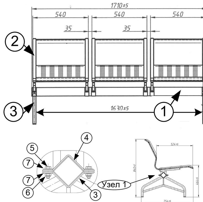
1. На балку (1) установить опоры крайние (3) и совместно с каркасами сидений (2) закрепить болтовыми соединениями (5,6,7) см. (Узел 1).
