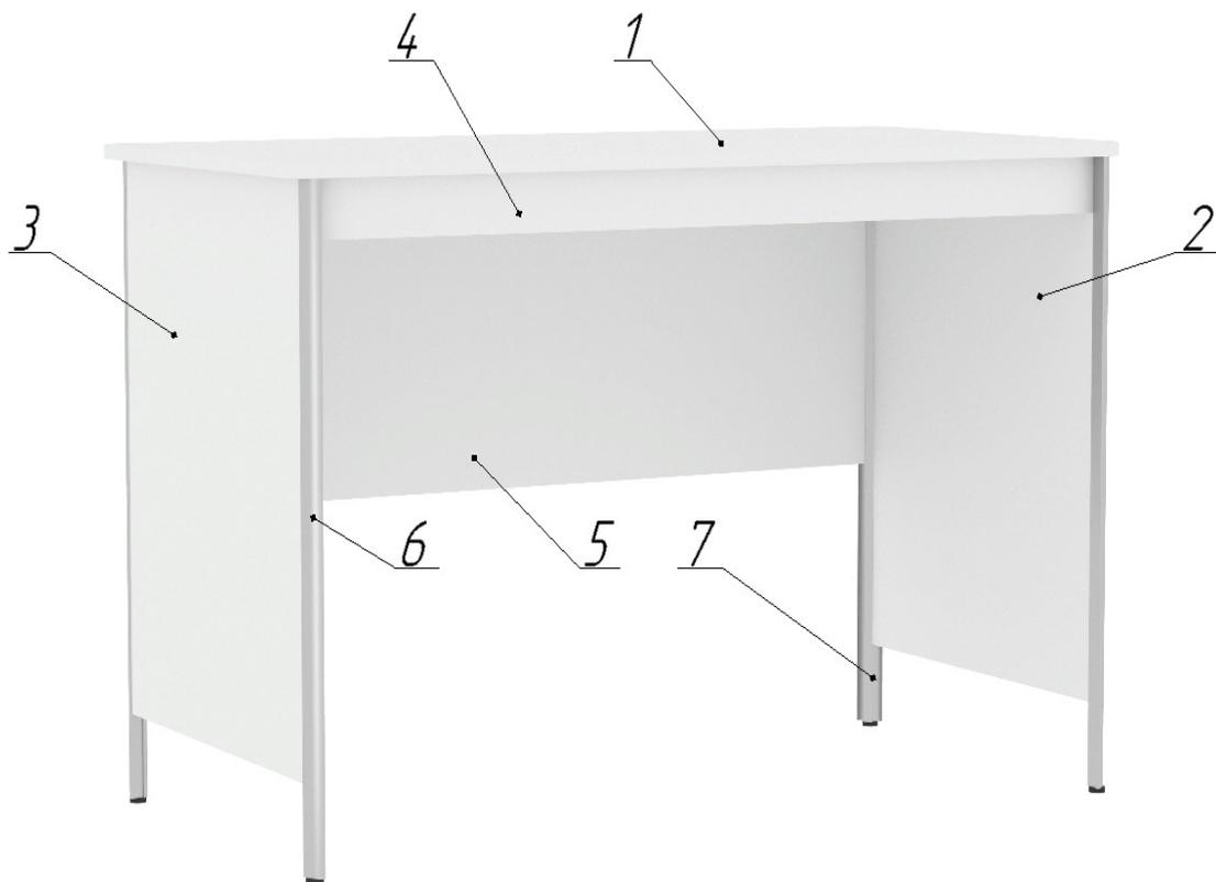
1. Скрепить с помощью штоков, эксцентриков боковые стенки (2,3) с передним профилем(6).
