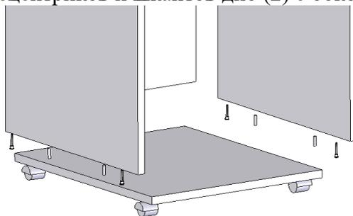
3. При помощи стяжек-эксцентров и шкантов сверху установить крышку (5).
