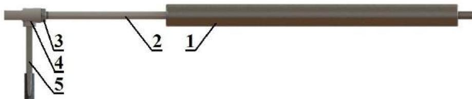
1. Ослабить гайку(поз.3) и повернуть головку(поз.4) по часовой стрелке по штоку(поз.2) до срабатывания пневмопружины(поз.1).
