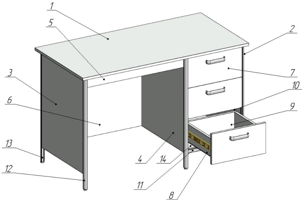
1. Скрепить с помощью штоков, стяжек-эксцентриков боковые стенки (2,3,4) с передним профилем(12).
