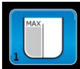
В этом случае, **выполнить циклы стерилизации невозможно..** Объем основного резервуара рассчитан примерно на 8 циклов для автоклава E9 NEXT 18L, и примерно на 7 циклов для автоклава E9 NEXT 24L.
