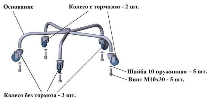
2. Держатель насадить на стойку с усилием исключая свободный съем его со стойки. С помощью винта М10х30 и пружинной шайбы 10 соединить стойку с основанием.
