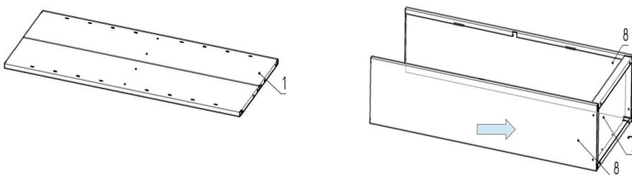
2. Вставить боковые стенки поз.8 в короб нижний поз.7 и закрепить при помощи саморезов 4,2x13.
