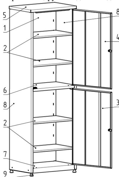
1. Соединить стенки задние поз.1 при помощи винтов и гаек М5. Работы производить на ровной и чистой поверхности.
