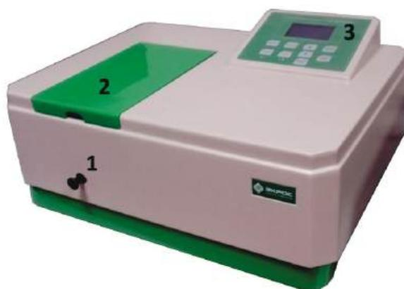
Рисунок 3 - Спектрофотометр ПЭ-5400ВИ.
