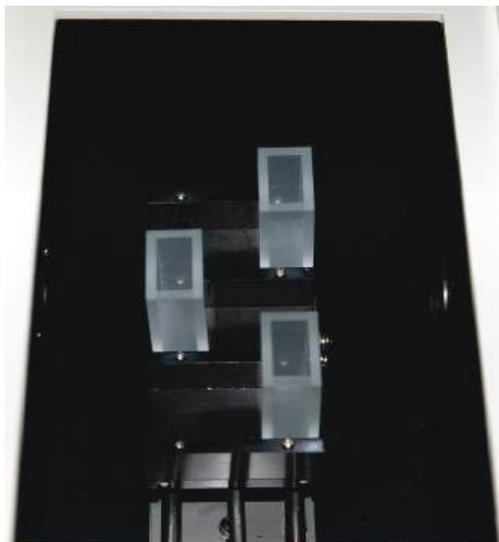
Рисунок 5 - Установка кювет в шахматном порядке.
