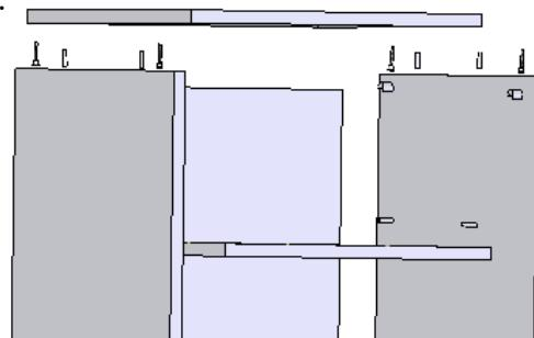
4. Прикрепить стенку заднюю (3) при помощи саморезов.
